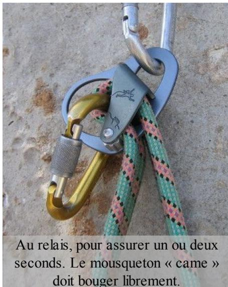
Au relais, pour assurer un ou deux seconds. Le mousqueton « came » doit bouger librement.
