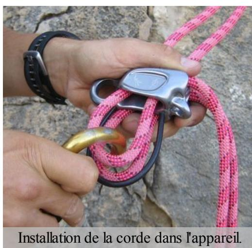
Installation de la corde dans l'appareil.
