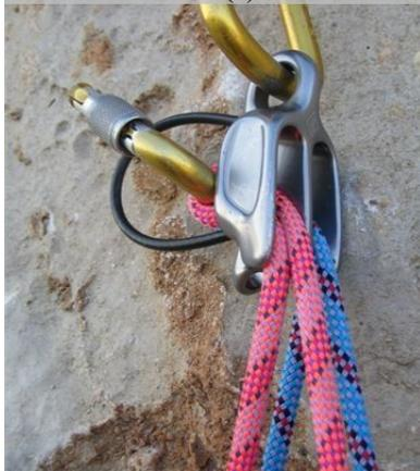
Cette installation permet, en cas de chute, **de bloquer la corde, de façon indépendante** sur l'ATC Guide, c'est-à-dire que si l'un des seconds tombe ( si vous grimpez en flèche ), l'assureur peut continuer à ravalé le mou de l'autre grimpeur. Cela peut s'avérer utile si, par exemple, un des seconds tombe pendant que l'autre est dans un passage difficile ( toit ou dévers, loin de la prochaine dégaine) ou si un des seconds a un problème, l'autre peut lui venir en aide...
