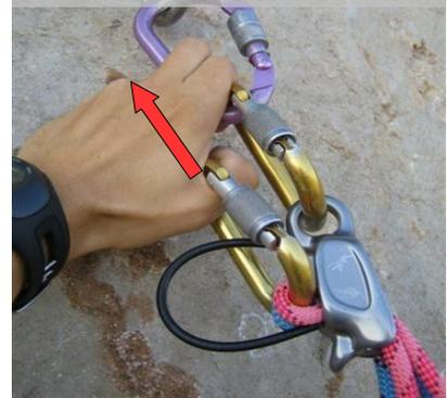
**Une des particularités astucieuse de l'appareil est ce petit oeillet** qui sert à déverrouiller la corde sous tension quand celle-ci est trop importante. L'oeillet étant bien placé, cela permet d'avoir un bras de levier suffisant. Il vous faudra par contre être en possession d'une cordelette ( donc, en prévoir une systématiquement ! ).Une fois la fameuse cordelette installée dans l'oeillet vous pourrez, soit tirer directement dessus avec la main et contrôler la descente avec l'autre main,
